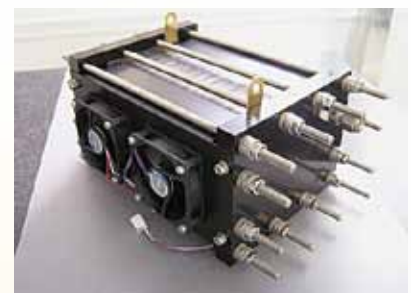
12V固体高分子形燃料電池スタック (弘大GOGOファンド産学官連携開発)
