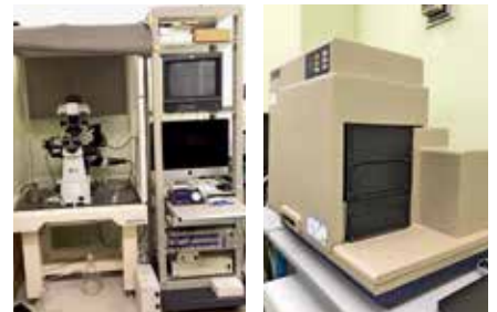
写真6 味覚受容体の機能を解析するための装置 イオンチャンネルの活動を観察するパッチクランプのセット（左）と、カルシウムイメージングなどに使用できるマルチモードマイクロプレートリーダー（右）。
