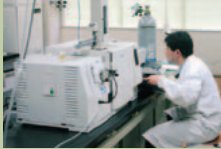
ガスクロマトグラフ質量分析計装置 - 分子量の測定に用いられる - 企業へ開放している機器一覧は、弘前大学機器分析センターホームページ上でご覧頂けます。
