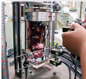
脊椎固定術の評価のための屈曲/回旋試験状況
