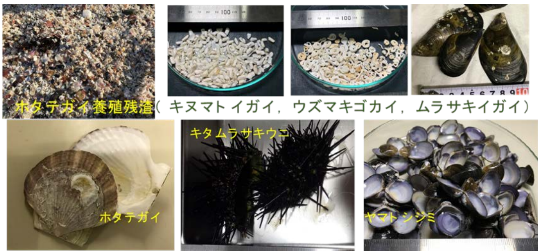
写真 焼成実験に用いた養殖残渣、貝殻およびウニ殻
