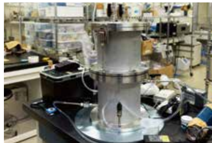
放射線検出器 防水膜のラドン透過性に関する実験。建物内のラドン(放射性ガス)を低減させる素材の有効性を調べます。
